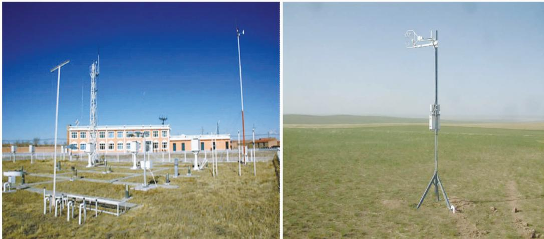
图 1 锡林浩特观测站及环境和近地层通量观测系统
