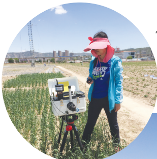
研究人员正使用热红外仪测量春小麦地表发射率。
